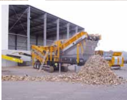
◀ Absiebung von Altholz nach vorgeschaltetem grobem Brecher
