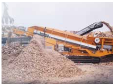
◀ Absiebung von Altholz nach vorgeschaltetem grobem Brecher
