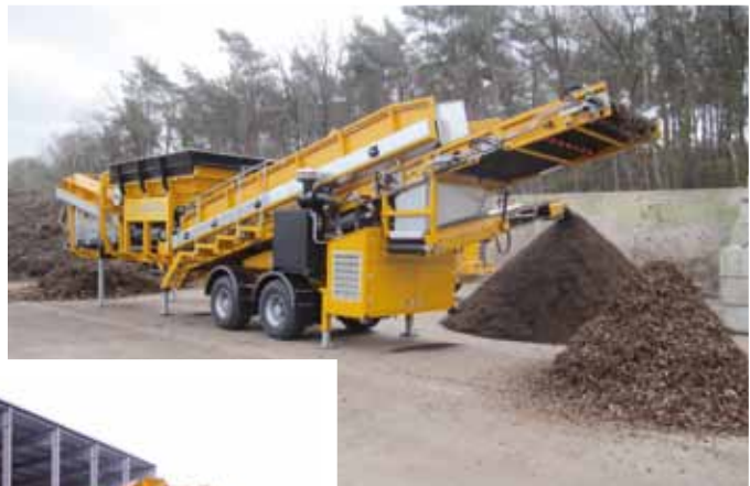
◀ Absiebung von Altholz nach vorgeschaltetem grobem Brecher
