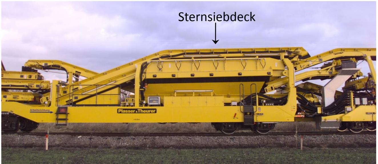
Ausbau des verunreinigten Bahnschotters aus den Gleisen
