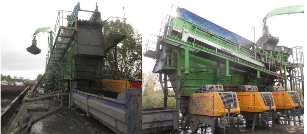
Sternsieb mit 1,7m Siebbreite als Schutzsieb für Kanalaushub- Förderpumpe.
