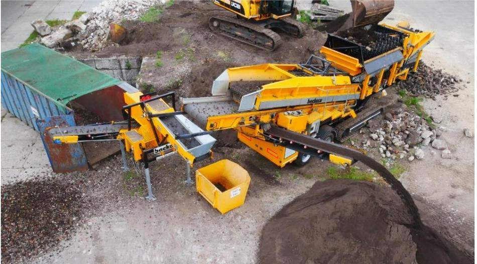
Bei der Übergabe dieser Fraktionen zum Windsichter wird Eisen durch eine Magnetrolle entnommen. Der Windsichter bläst danach Leichtanteile mit einem einstellbaren, starken Luftstrom aus. Die Aufbereitung geschieht ohne händische Trennung.
