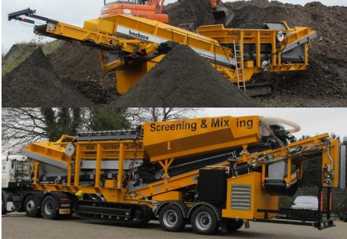
Das Sternsieb kann insbesondere auch bindigen Boden mit hohem Durchsatz sieben. Die groben Anteile fallen vor der Maschine ab. Mittel- und Feinkorn hinten und seitlich.
